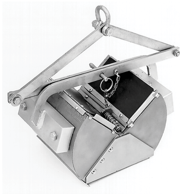
Figure A-9. Ponar Grab Sampler
