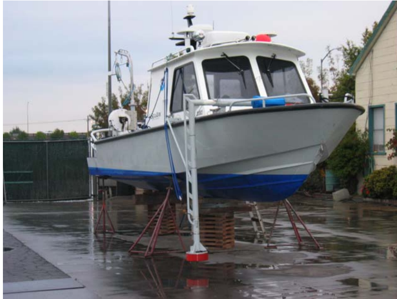
Simrad EM 3000 Multibeam Arm on S3003
