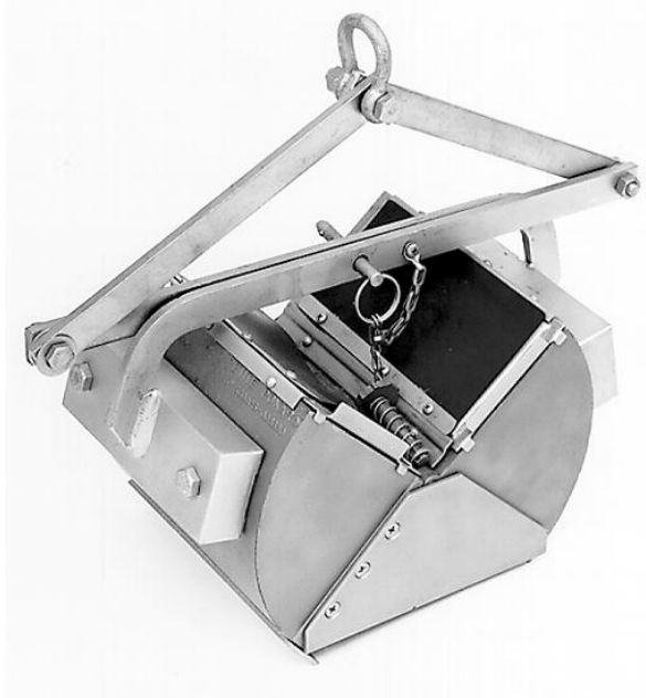
Figure A-10. Ponar Grab Sampler
